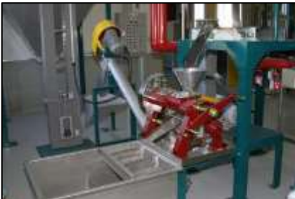
菜種から油を搾るプラント。搾った油は熱処理して精油し、瓶詰にします。
